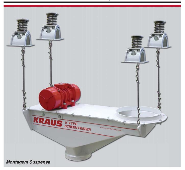
A Peneira Alimentadora Tipo K da Kraus é uma combinação que utiliza um ou dois compartimentos de peneira com um condutor de força bruta e apenas um motovibrador elétrico. É ideal para peneirar materiais secos a granel de partículas com 1 polegada até 100 Mesh de dimensão. A Peneira Vibratória Tipo K Kraus pode ter controle de vazão e ser acoplada diretamente
