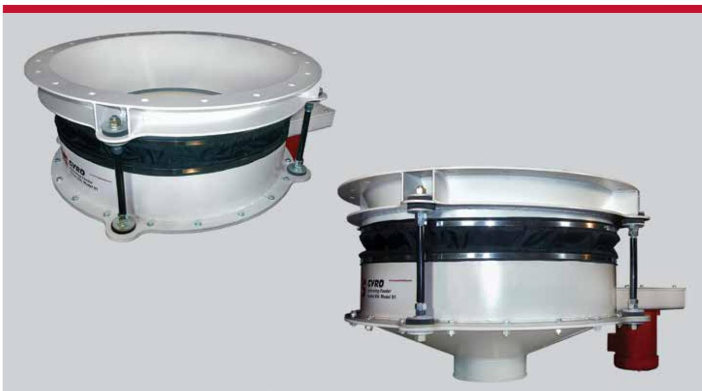
O alimentador ativador de silos Kraus GYRO produz 360 graus de movimento puramente giratório para descarregar, de maneira mais confiável e positiva, materiais granulados de silos, moegas e recipientes de armazenamento a qualquer taxa de alimentação desejada.
